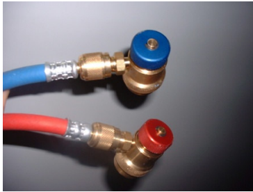
Afbeelding 9a - Hoge- en lagedruk snelkoppelingen
